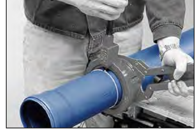
Kesici ve pah aleti ile boy kesme (ŞEKİL 16)
