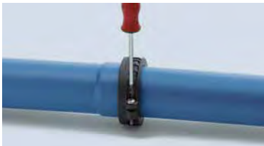
Şimdi vidayı sıkın. İzin verilen maksimum tork 7 Nm'dir. DN/OD 32–90 boyutlarındaki bağlantı parçaları, POLO-KAL NG ASV kurulmadan önce 5 mm çekilmelidir. (ŞEKİL 3)
