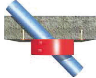
Zemin – özel kurulum "45°'de çapraz bağlantı" (ŞEKİL 62)
