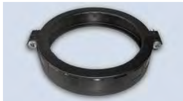
DN/OD 90 veya daha büyük boyutlara sahip braketter 2 vidayla donatılmıştır. İzin verilen maksimum tork 7 Nm'dir. (ŞEKİL 4)
